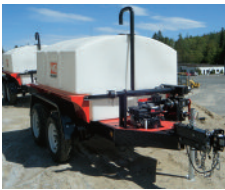
MULTIQUIP , remorque à eau, moteur Honda, 500 gallons, 158 gpm, freins hydr., barre d'arrosage
