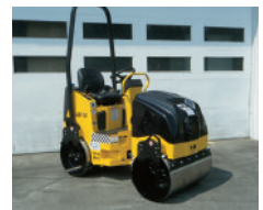
MQ AR14H , moteur Honda GX630, largeur 36", 2,690 lb, avec vibration
