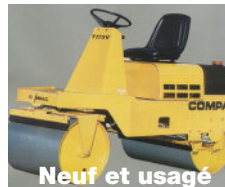
COMPAC T175V , Honda 20 hp, largeur 38", 3 000 lb, avec vibration
