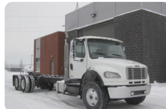
FREIGHTLINER M2-106 2011 Cummins ISC 260 hp, Allison automa- tique, essieux 14/40, suspension à air Stock 633076
