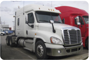
FREIGHTLINER Cascadia 2013 moteur Detroit DD15, 475 hp, transm. 10 vitesses auto "Shift", essieux 12/40, suspension à air Stock 485294
