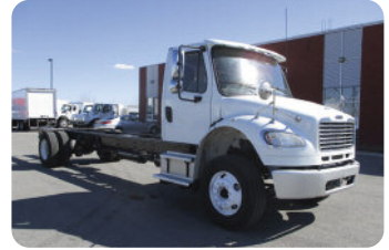
Freightliner M2-106 2014 Cummins ISL 8.3L 260 hp, automa- tique Allison, essieux 12/23, suspension à air Stock 531986
