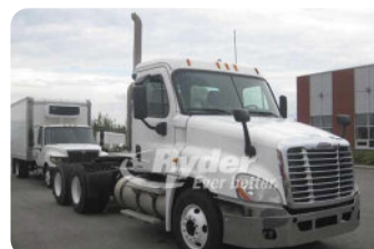
FREIGHTLINER Cascadia 2010 moteur Detroit 14.0 L 470 hp, 18 vit., essieux 12/46, suspension à air Stock 620688
